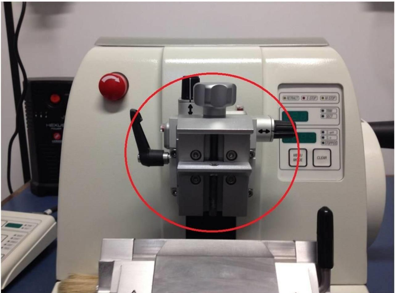
Figura 1. Visão do braço rotativo.
