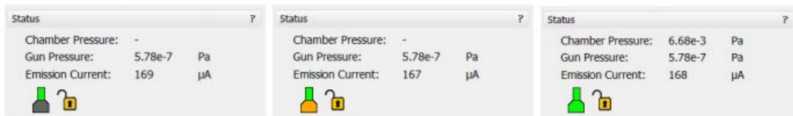
Figura 13. Sequência de mudanças no indicador de pressão durante o evacuação da câmara.
