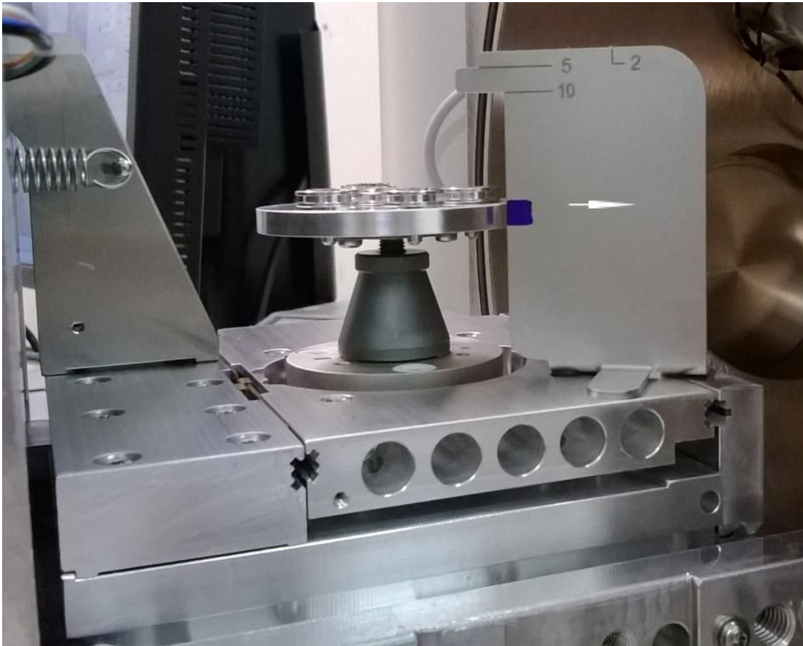
Figura 14: Indicação da altura ideal em azul na qual o porta amostra deve ser ajustado.
