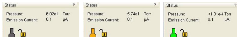
Figura 20: Sequência do indicador de pressão após, pressionado o botão “ Pump ”.
