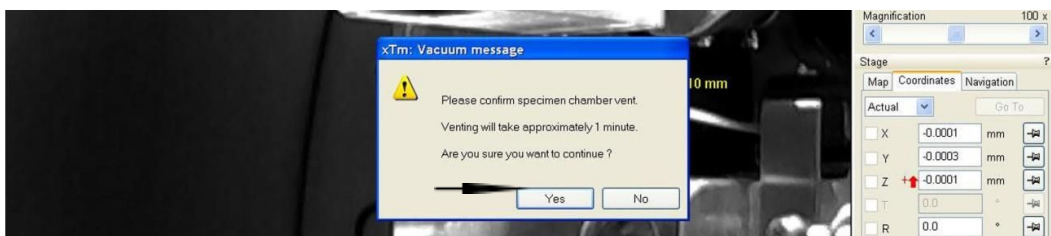
Figura 11: Confirmação da opção de despressurização da câmara (“Vent”).
