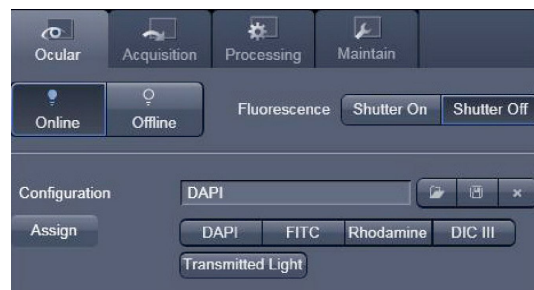
Figura 12. Visão da aba ocular mostrando a função liga e desliga da lâmpada de configuração pré-estabelecida pelo software .
